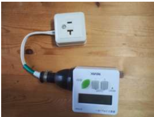
写真は電力計にコンセントを付加した状態
